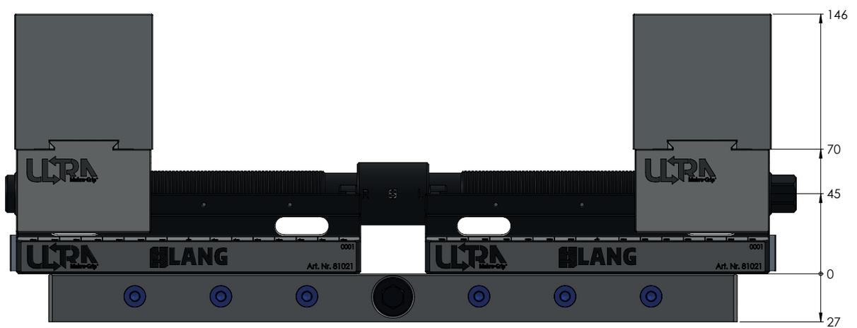
Die oben gekennzeichneten Werte gelten auch für die Einheiten mit den Längen 610 & 810 mm
