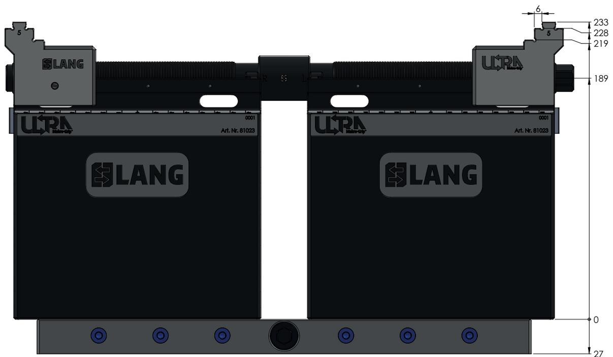
Die oben gekennzeichneten Werte gelten auch für die Einheiten mit den Längen 610 & 810 mm
