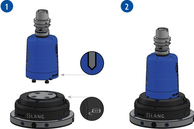
Spannmittelhaube wird samt verriegeltem 5-Achs-Spanner aus dem Werkzeugmagazin in die Maschinenspindel eingewechselt.
