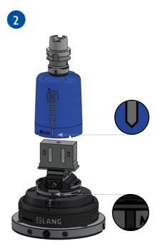
Die leere Spannmittelhaube wird aus dem Wekzeugmagazin in die Maschinenspindel eingewechselt.
