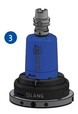
Maschinenspindel fährt sanft auf Position bis die Spannmittelhaube in ihrer Endposition angekommen und entriegelt dabei den Klemmmechanismus durch Herunterdrücken des Betätigungsstiftes.
