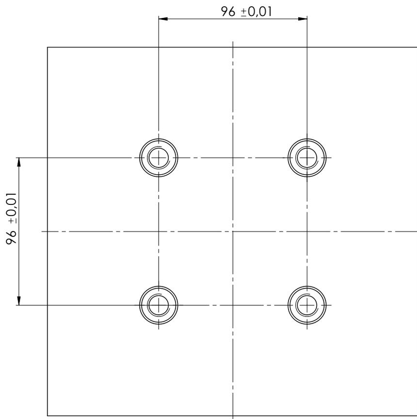
**Das Einbringen der Aufnahmebolzen in eigene Spannmittel und Vorrichtungen muss im Maß  $96 \text{ mm} \pm 0,01 \text{ mm}$  erfolgen.**
