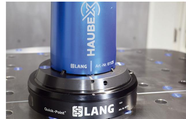
2 Die in der Spindel eingesetzte Haube fungiert über Nuten wie ein großer Steckschlüssel. Mit einer Vierteldrehung der Spindel verriegelt sie das Nullpunktspannsystem rein mechanisch © Hanser
