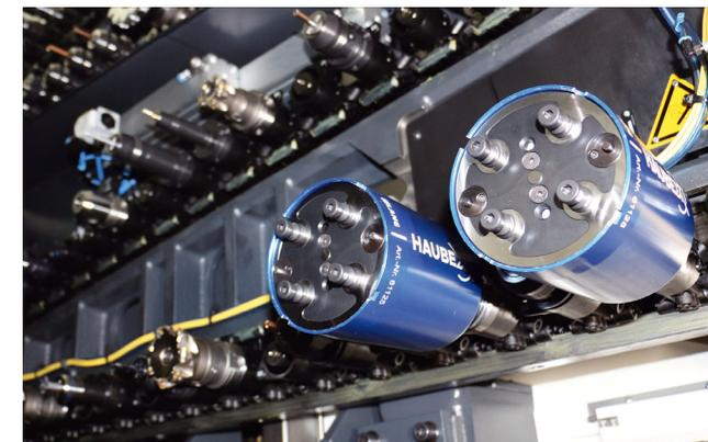
3 Mit zwei Haubex bestücktes Werkzeugmagazin. Mit der passenden Werkzeugaufnahme ausgerüstet, sind keine maschinenseitigen Anpassungen nötig © Hanser
