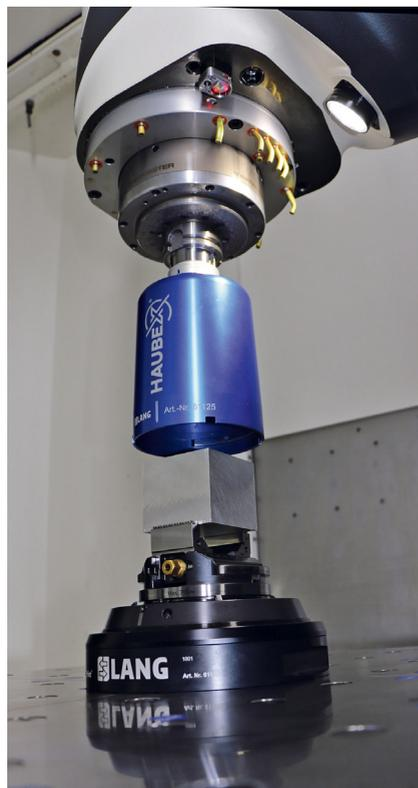
1 Einfacher Einstieg in die Automatisierung mit Haubex, dem Werkstückspeicher aus dem Werkzeugmagazin, der über den Schwertwechsler in die Spindel und von dort auf den Maschinentisch eingebracht wird © Hanser
