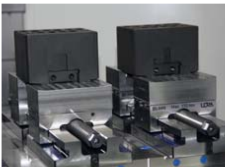
Grundkörper: Drei verschiedene Systemhöhen (45/109/189 mm) in je zwei unterschiedlichen Längen.
