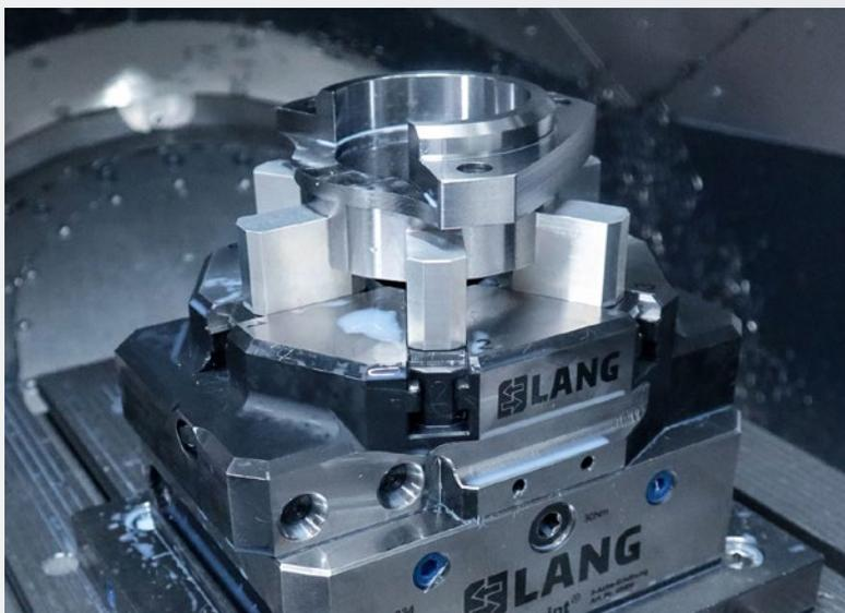
Vasto-Clamp 6-Jaw Chuck. Image: CNC-Technik Ortlieb GmbH & Co. KG.
